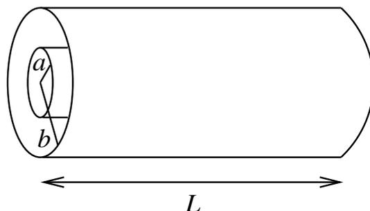
Sejam  $+Q$  e  $-Q$  as cargas livres nos cilindros de raios  $a$  e  $b$ , respectivamente. O espaço entre os cilindros é inteiramente preenchido com um material de constante dielétrica  $\kappa$ . Ignorando-se a região das bordas, campo elétrico entre os cilindros na ausência do dielétrico é dado por
