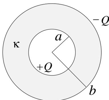
Carrega-se o condutor interno com carga  $+Q$  e o externo com carga  $-Q$  (cargas livres). O campo elétrico devido apenas a essas cargas livres é
