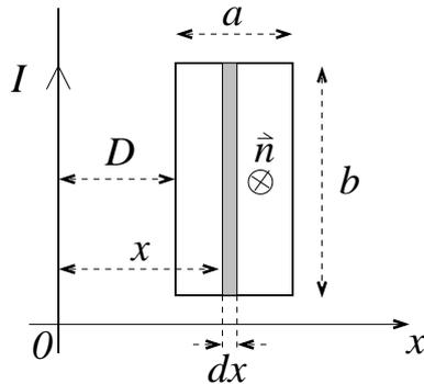
Escolhemos a normal  $\vec{n}$  da área da espira entrando no plano da figura. Assim,  $\vec{B}$  e  $d\vec{A} = b dx \vec{n}$  são paralelos e
