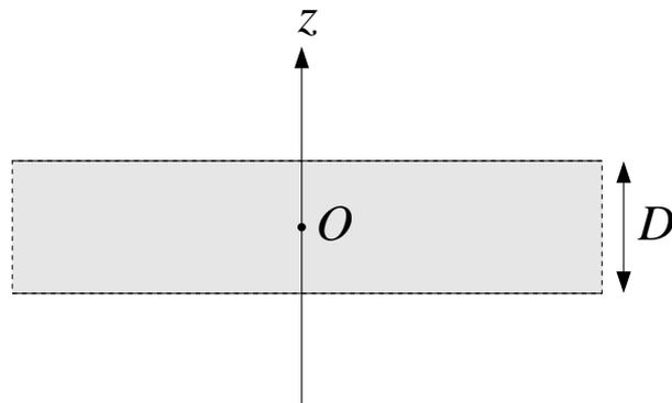
Na figura, a chapa isolante de espessura  $D$  possui densidade de carga elétrica positiva  $\rho$ , uniformemente distribuída em seu volume. Supondo a chapa plana e infinita nas direções  $x$  e  $y$ , calcule o **vetor** campo elétrico
