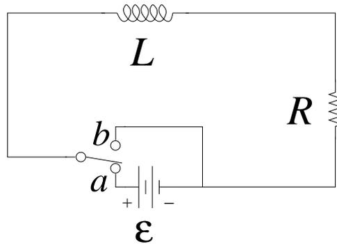
O circuito da figura é composto de uma fonte de força eletromotriz  $\mathcal{E}$ , de um resistor  $R$  e de um indutor  $L$ .
