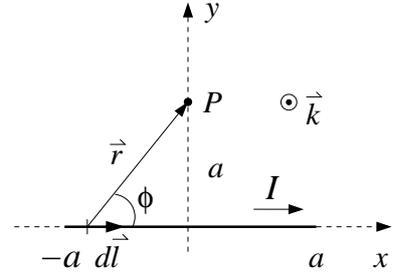
Da figura obtemos  $d\vec{\ell} \times \vec{r} = dx r \sin\phi \vec{k}$  e  $\sin\phi = a/\sqrt{x^2 + a^2}$ . Assim,
