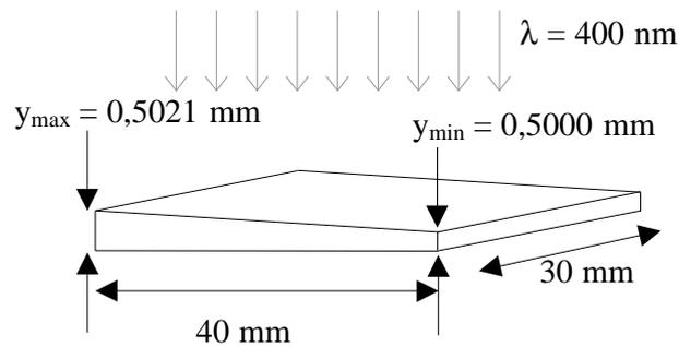
A lâmina foi testada no ar com um feixe de luz monocromática com comprimento de onda  $\lambda = 400 \text{ nm}$  incidindo verticalmente. Visto de cima, observou-se uma imagem com várias franjas paralelas, conforme o desenho abaixo
