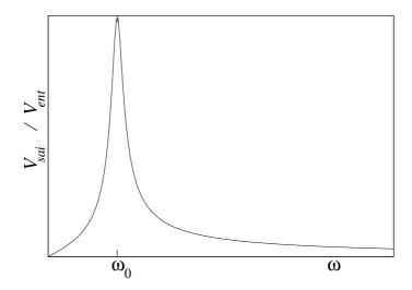
(c) Na ressonância  $\omega L=1/(\omega C)\Rightarrow Z=R$ . Substituindo este resultado na expressão do item (a) obtemos  $V_{sai}/V_{ent}=1$ .
