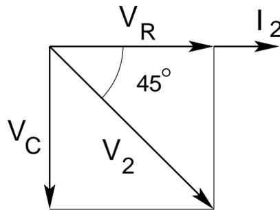
As tensões máximas no resistor e no capacitores são
