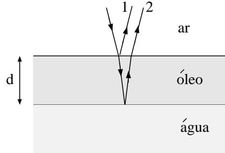
Por outro lado, como  $n_{\text{óleo}} > n_{\text{água}}$ , não há defasagem de  $\pi$  na reflexão do raio 2. A mudança de fase é devida apenas à distância extra  $2d$  que o raio 2 percorre em relação ao raio 1. A diferença de fase entre os raios 2 e 1 é
