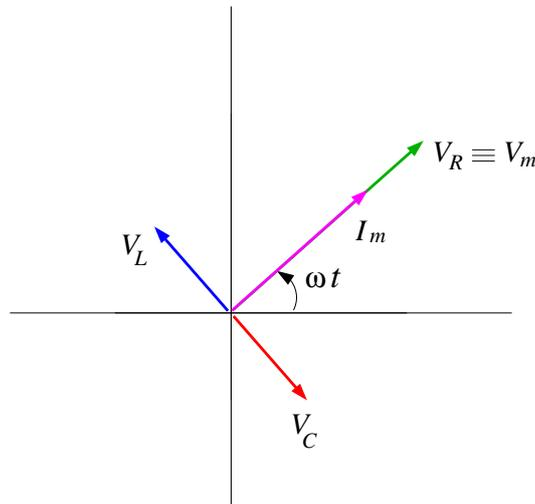
O fasor  $V_m$  é a soma vetorial dos fasores das voltagens no indutor, no capacitor e no resistor. Como  $V_L = \omega L = 1/(\omega C) = V_C$  a soma vetorial dos fasores das voltagens no indutor e no capacitor é zero e portanto o fasor  $V_m$  é igual ao fasor  $V_R \implies \boxed{V_m = V_C}$ . Isto também pode ser demonstrado lembrando que  $V_m = ZI_m = RI_m = V_R$  uma vez  $Z = \sqrt{R^2 + (L\omega - 1/(C\omega))^2} = R$ .
