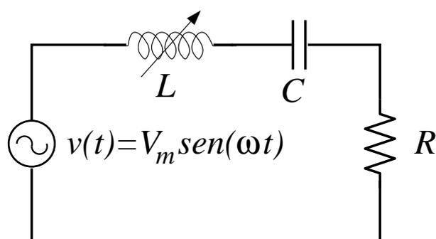
O gerador de corrente alternada fornece uma tensão  $v(t) = V_m \text{sen}(\omega t)$ . A indutância  $L$  é variável e é ajustada de tal forma que a defasagem entre a voltagem do gerador e corrente no circuito é zero. Os valores de  $V_m$ ,  $\omega$ ,  $C$  e  $R$  são conhecidos.
