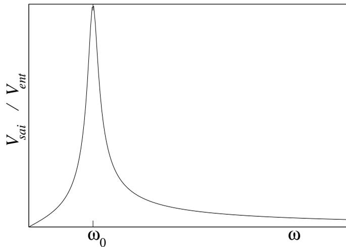
(c) Na ressonância  $X_L = \omega_0 L = X_C = 1/(\omega_0 C)$ . Assim,  $\tan \phi = \tan(X_L - X_C)/R = 0 \implies \phi = 0$  e portanto não há defasagem entre a corrente e a voltagem.
